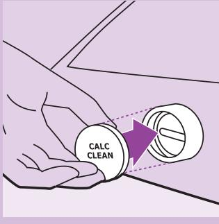
**9** 将水垢清洗钮装回蒸汽箱。
