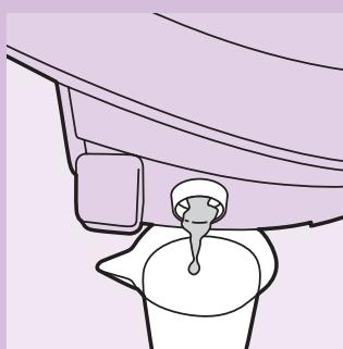
**7** 清空蒸氣槽，將蒸氣槽中的水倒入杯中或水槽中。
