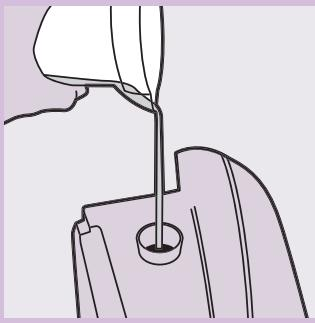
**6** 用杯子将蒸汽箱注满清水，然后继续摇动。
