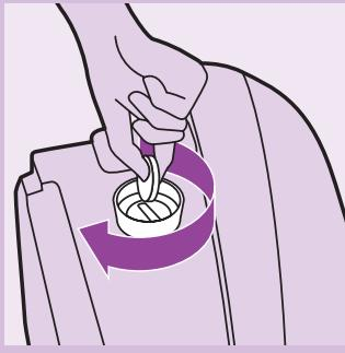
**8** 将清洗帽和清洗塞放回蒸气箱，然后用硬币拧紧。
