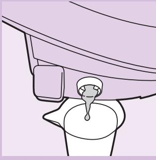
**7** 将蒸汽箱中的水倒入杯子或水池内。
