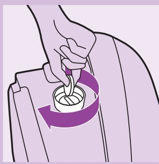
**8** 將除鈣沖洗孔栓塞裝回蒸氣槽上並使用一個硬幣鎖緊。
