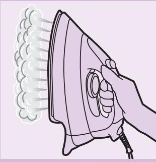
▶ 蒸汽熨烫可用于悬挂的窗帘和衣物（夹克，西装，外套），这时将熨斗竖起来，按下蒸汽启动器即可。
